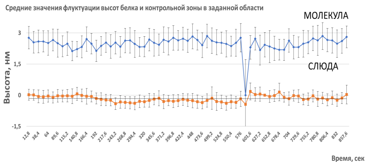
Рисунок 1.22 – Пример определения референсных значений колебаний высоты молекулы. Стандартное отклонение амплитуды колебания заданной области в пределах одной молекулы составило 0,22 нм. Стандартное отклонение амплитуды колебания заданной области в пределах контрольной зоны (подложка без белка) – 0,12 нм. Область обсчета, выделенная алгоритмом обработки в обоих случаях – составила 16x16 pix
